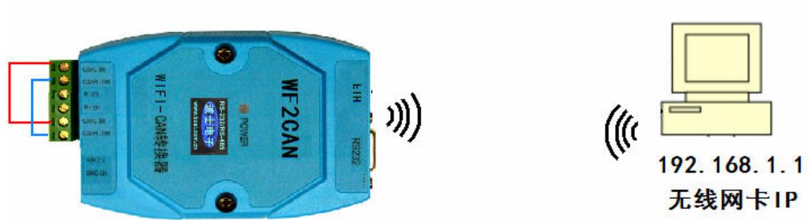
用电线将 CAN1H 与 CAN2H 短接、将 CAN1L 与 CAN2L 短接，用于测试 1 号 CAN 口与 2 号 CAN 口之间进行数据传输。默认波特率 100K。将计算机的无线网卡（WIFI）口的 IPv4 地址设置为 192.168.1.1（最后以后 1 到 254 均可），子网掩码 255.255.255.0。
