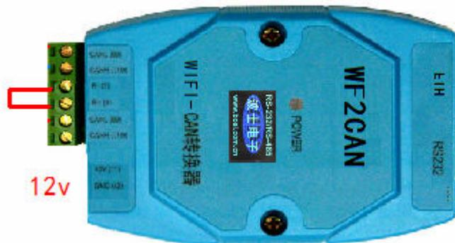
用电线将 RESet1 与 RESet2 短接、然后再插 12v 电源。过 15 秒钟后拔下电源，再断开 RESet1 与 RESet2。
