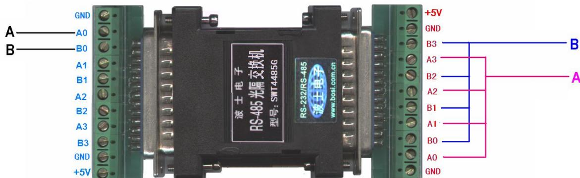
从功能上来讲，交换机 SWITCH 是可以代替集线器 HUB 的，而集线器 HUB 是可以代替中继器 REPEATER 的，所以交换机最强大。当 SWT4485G 每一侧只用一路 RS-485 时，相当于 RS-485 中继器。SWT4485G 作为中继器与普通的 RS-485 中继器的区别在于 SWT4485G 可以有 4 倍的驱动能力。如果把 SWT4485G 的下位机端的 4 路 RS-485 的 A0、A1、A2、A3 短接在一起共同作为 A，B0、B1、B2、B3 短接在一起共同作为 B，则下位机侧的 RS-485 驱动能力为 4 倍。当然也可以只短接 2 路或 3 路。注意上位机侧的 RS-485 不要这样短接，只使用其中任意一路 RS-485 即可，因为上位机侧是作为负载被驱动的，越小越好。
