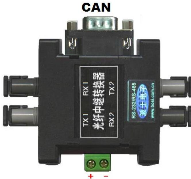
直接使用 DB-9 针座的 CAN 口
