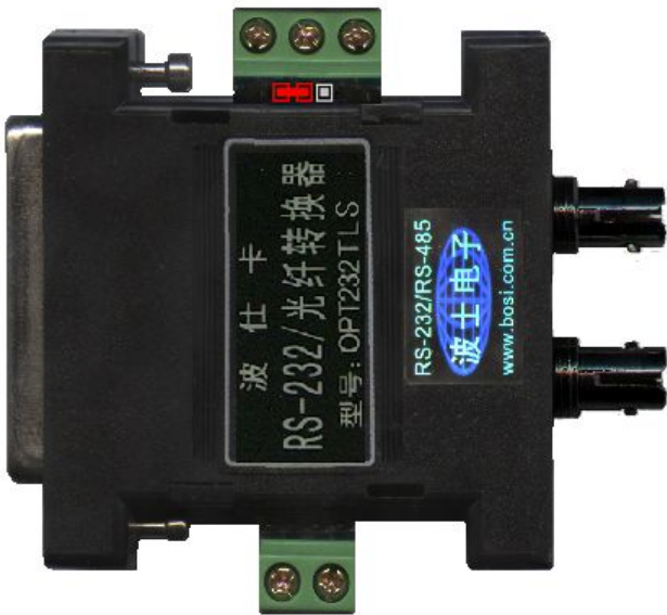
接 RS-232 时 (注意上侧面跳线靠 RS-232 口侧短接)
