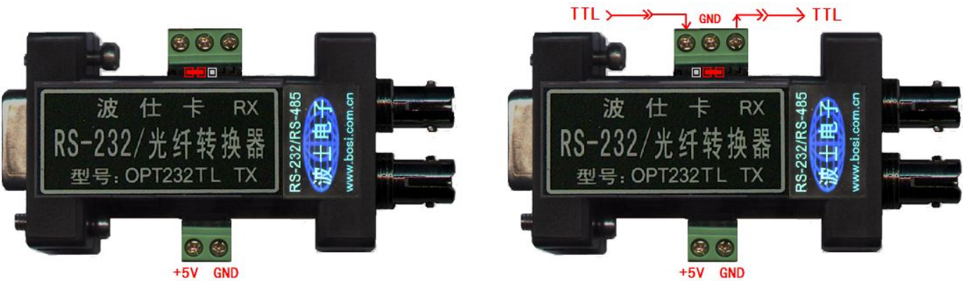
接 RS-232 时 (注意上侧面跳线靠 RS-232 口侧短接)
