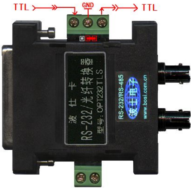
接 TTL 时 (注意上侧面跳线靠光纤侧短接)
