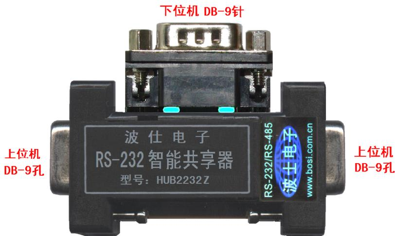
HUB2232Z 的外型为 DB-9（孔）/DB-9（孔）转接盒大小，其中两个 DB-9 孔可以直接插在 PC 机的 DB-9 针座 RS-232 串行口上，中间一个 DB-9 针的引脚分配同计算机的 RS-232 口，但是只有 RXD、TXD、GND 三线。HUB2232Z 无须外接电源！
