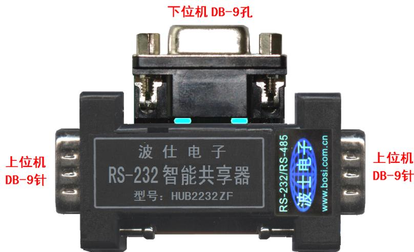
HUB2232ZF 的外型为 DB-9（孔）/DB-9（孔）转接盒大小，其中两个 DB-9 孔可以直接插在 PC 机的 DB-9 针座 RS-232 串行口上，中间一个 DB-9 针的引脚分配同计算机的 RS-232 口，但是只有 RXD、TXD、GND 三线。HUB2232ZF 无须外接电源！
