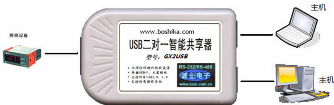
我们经常使用将一个 USB 扩展为多个 USB 口的装置，那叫 USB 集线器（USB HUB）。它有一个 USB 口接计算机，多个 USB 口接设备。反过来，如果需要一个 USB 口接设备，多个 USB 口接计算机呢？这种装置就称为 USB 共享器，或者 USB SHARE。USB 共享器用于多个计算机通过 USB 口共享一个 USB 设备，比如经常有多个计算机共用一台打印机，这时就需要 USB 共享器。
