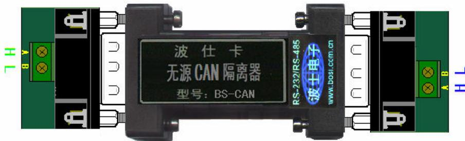
随着现场总线的日益广泛的使用，人们逐步解决了简单总线信号的无源隔离，比如 RS232 隔离，比如 4—20mA 电流环的无源隔离。2014 年 8 月，波仕电子正式发布型号为 BS-CAN 的“无源 CAN 隔离器”，适应所有 CAN 通信软件也无需任何设置。与以前的型号 YG-CAN 相比，新产品 BS-CAN 实现了无需供电，而 YG-CAN 则需要接 5V 电源供电。BS-CAN 支持的最高波特率也增加了一倍，达到 250Kbps。
