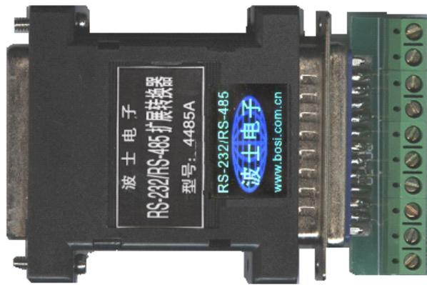
4485A 的外形为 DB-25（孔）/DB-25（针）转接盒大小，其中 DB-25 孔座直接外插 DB-25 芯 RS-232 串行口，DB-25 针座配套有接线端子板，可以直接接 4 个 RS-485 口。使用之前通过软件设置来分时选通四个 RS-485 口。4485A 还配有 DB-25（针）/DB-9（孔）延长电缆（1 米长），用于使 4485A 可以外插 DB-9（针座）的 RS-232 串行口。4485A 无须外接电源！
